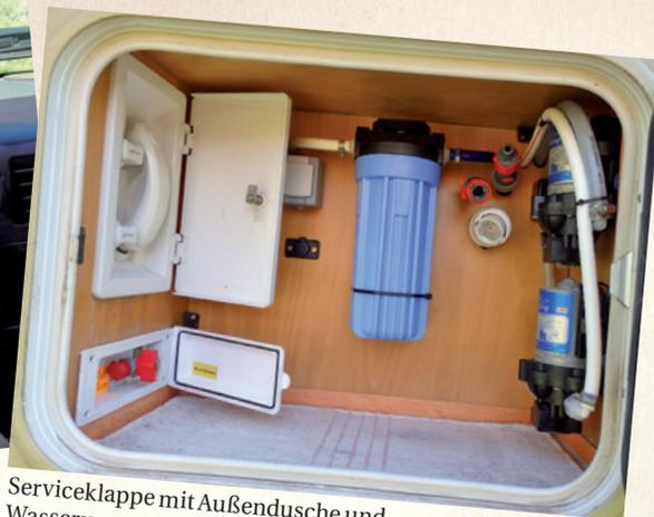
Serviceklappe mit Außendusche und Wasserversorgung
